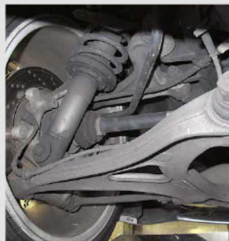
Poltern aus den Aufhängungen stammt oft von den verschleißfreudigen Stoßdämpferbuchsen
