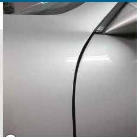
3 Die Spaltmaße waren ab Werk ungleichmäßig und taugen nicht als Unfall-Indikatoren
