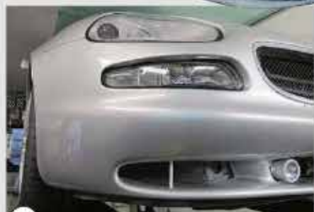
7 Frontschürzen leiden unter Aufsetzern, Ersatz gibt es nur noch gebraucht
