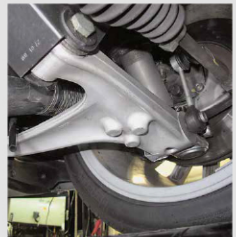
Einteilige Querlenker-Traggelenk-Kombination: Ab 140.000 entwickeln sie Spiel
