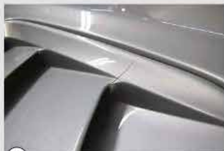
4 Bruchfreudig: Die Entlüftungsgitter oben in der Motorhaube zeigen meist Risse
